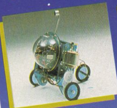
PIPER MOUSE MV-915 Usando un fischietto unito al kit PIPER MOUSE eseguirà immediatamente i comandi comunicativi: sinistra, stop, destra, stop, avanti e stop.
